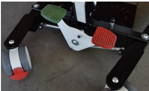
Fig. 4 – Pedaal voor de pootspreiding.
