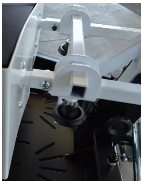
Fig. 5 – Diepte en breedteverstelling onderbeensteun.
