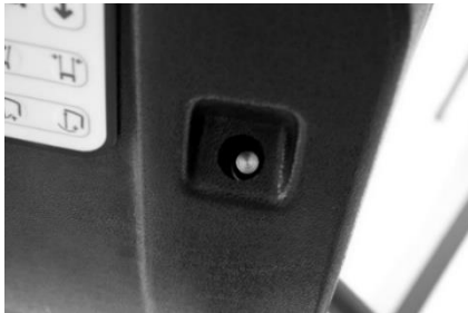
Afbeelding 18 - handmatige nooddaalfunctie met de sleutel voor nooddaalfunctie
